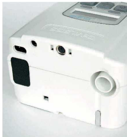
Ściana tylna SleepCube – filtr oraz podłączenie obwodu pacjenta
